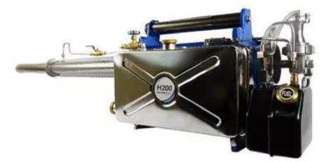
Los termonebulizadores **VECTORFOG®** cuentan con encendido automático; nebulizan por medio de aire comprimido. Al presionar el botón de encendido, inicia la compresión. El aire comprimido también presuriza el depósito de combustible lo cual resulta en una inyección de combustible desde la boquilla hacia el carburador.
